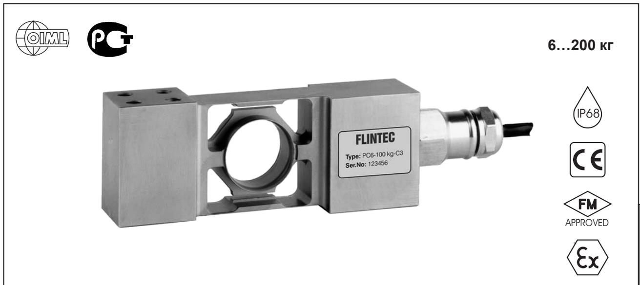
Тензометрический датчик на сдвиг серии PC6 технологии SINGLE POINT минимизирует действие паразитных нагрузок и боковых смещений. Датчик изготовлен из нержавеющей стали и обладает высоким классом защиты (IP68). Применяется для сложных условий эксплуатации (в пищевой промышленности, при возможных контактах с агрессивными средами).
