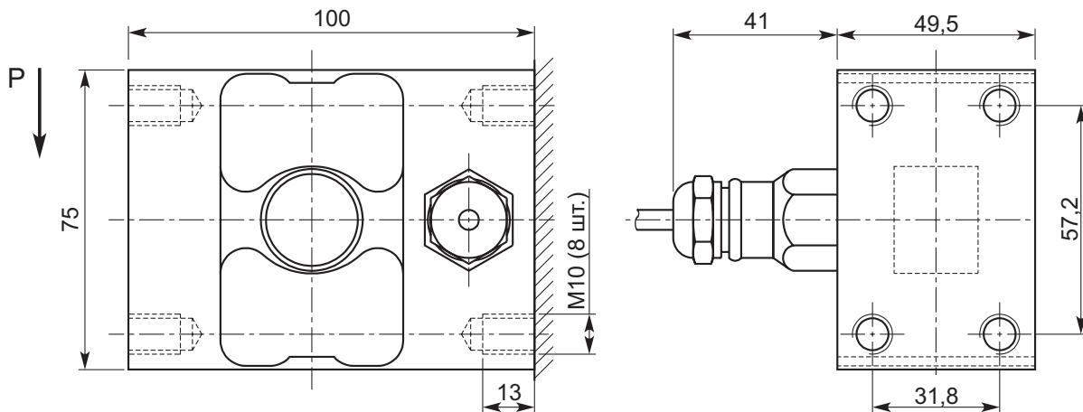
Монтажные болты М10 8.8; момент затяжки 50 Нм. Резьбовое соединение перед монтажом смазать.
