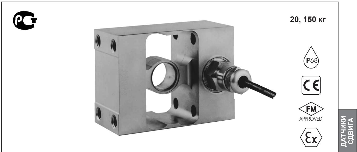
Тензометрический датчик сдвига серии РС2 с номинальными нагрузками 20 кг и 150 кг. соответствует классу точности С3. Рекомендуемый максимальный размер платформы весов, в которых используется датчик, 1000x1000 мм.
