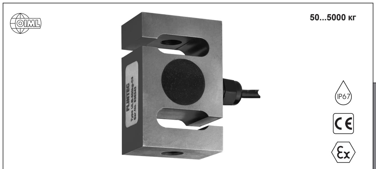
Принцип действия тензометрического датчика S-образного типа основан на преобразовании деформации растяжения/сжатия вдоль площадок главных напряжений упругого элемента в электрический сигнал. Тензорезисторы, элементы нормирования и термокомпенсации соединены по мостовой схеме Уитстона (Wheatstone).
