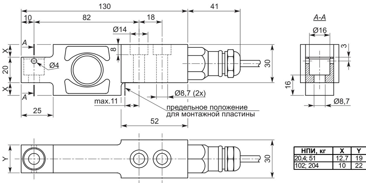
Монтажные болты М8 8.8. Момент затяжки 25 Нм.
