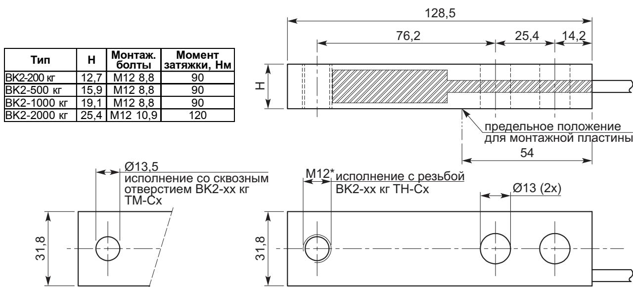
\* Резьбовое соединение перед монтажом смазать.
